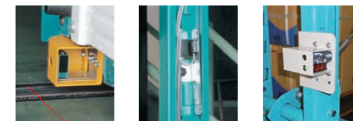
セーフティセンサー (レール式・レールレス) 進入センサー (レール式) 進入センサー (レールレス)
